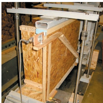
根据APA性能分等的封边梁样品在APA研究中心评估其结构性能。
