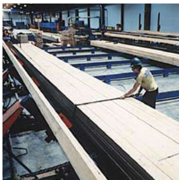
胶合梁可以定制加工成任意长度、高度和宽度
