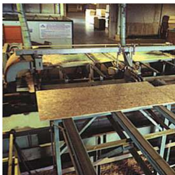
定向刨花板生产过程允许创新技术的加入，如在屋面覆面板上增加防滑纹理
